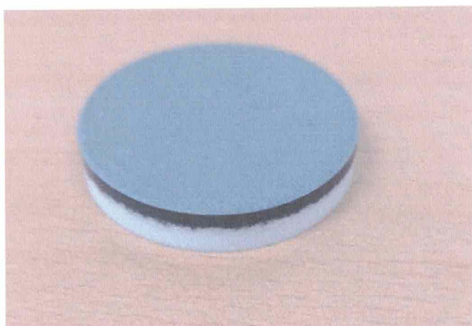
Фиг. 1. Пресована и таблетна проба за химичен анализ
